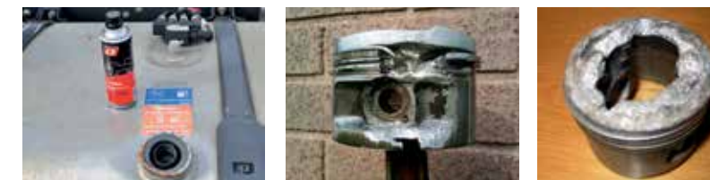
Posljedica detonatnog izgaranja uslijed kvara injektora
